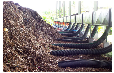
Die Biomasse wird belüftet, damit die Kompostierung aerob statt findet und somit anstelle von Methan Kohlendioxid und Abwärme entsteht.
